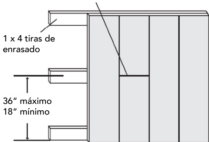
Figura 1 Haga coincidir la unión del extremo y el clavo sobre las tiras de enrasado
